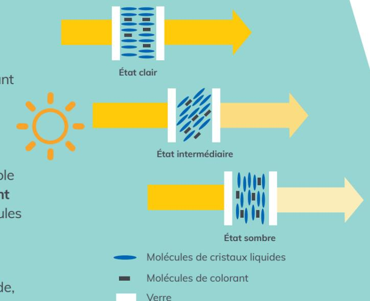
Sous l'effet d'une faible tension électrique, les cristaux liquides changent d'orientation, entraînant les molécules du colorant, et régulent ainsi la quantité de lumière et de chaleur qu'ils laissent passer.
