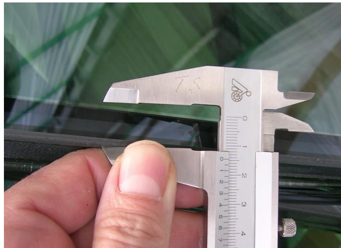
Randentschichtung am Randverbund eines Sonnenschutzglases
