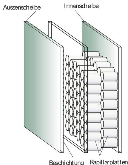
Der 2-fach-Aufbau besteht aus einem 20 mm Scheibenzwischenraum mit zwei versetzten Kapillareinlagen mit je 10 mm Stärke, in der Regel ohne zusätzliche Beschichtung.
