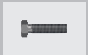
Vis à 6 pans M 7x28 A4-80 (Vis du système Flat) Perçage aluminium \varnothing 7,5 Douille SW 11
