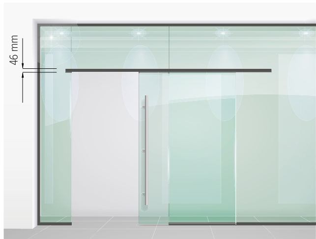
Schiebetürbeschlag und Zarge haben die gleiche Ansichtsbreite
